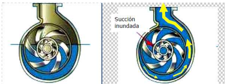
Oído o entrada del rodete Con aire, imposible succionar
